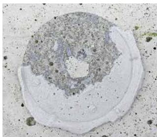
Sehr gute Adhesion auch zwischen Kleber und Packer Très bonne adhésion aussi entre l'adhésif et l'injecteur
