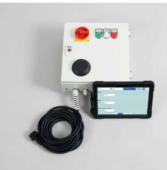
Schaltschrank (logging) mit Tablet Armoire de commande (enregistrement) avec tablette
