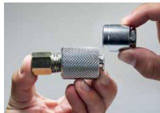
Schiebekupplung auf den Flachkopfnippel aufchieben | Glisser l'accouplement coulissant sur le nipple à tête plate
