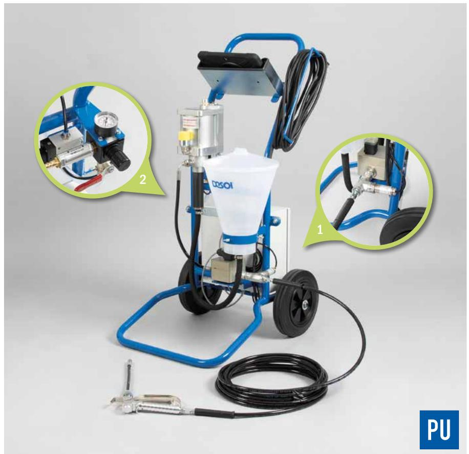
1. Druckminderer mit Manometer | Pressure regulator with manometer
